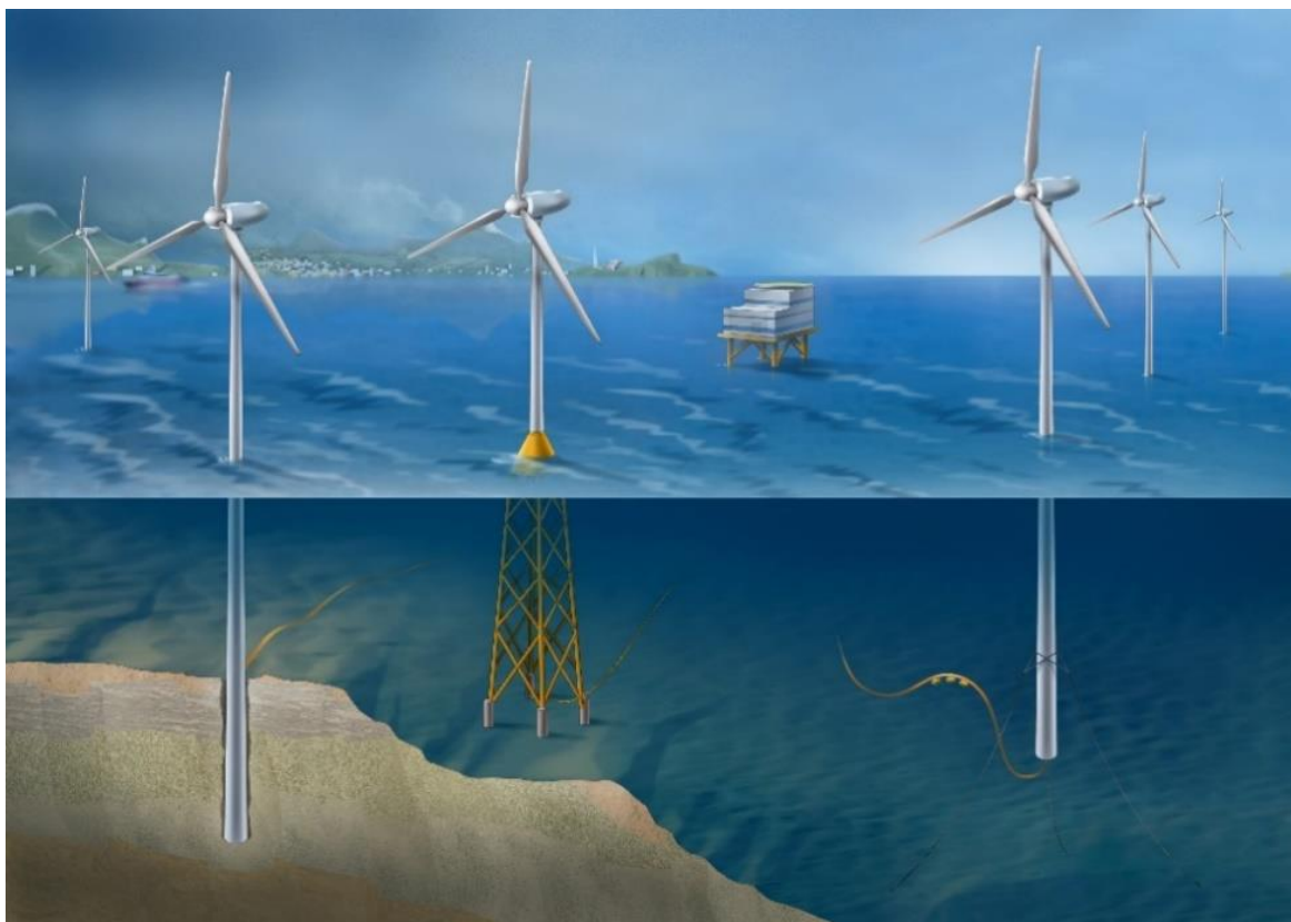
Figur 14: Havvind – bunnfast og flytende (Kilde; NOWITECH/SINTEF)
