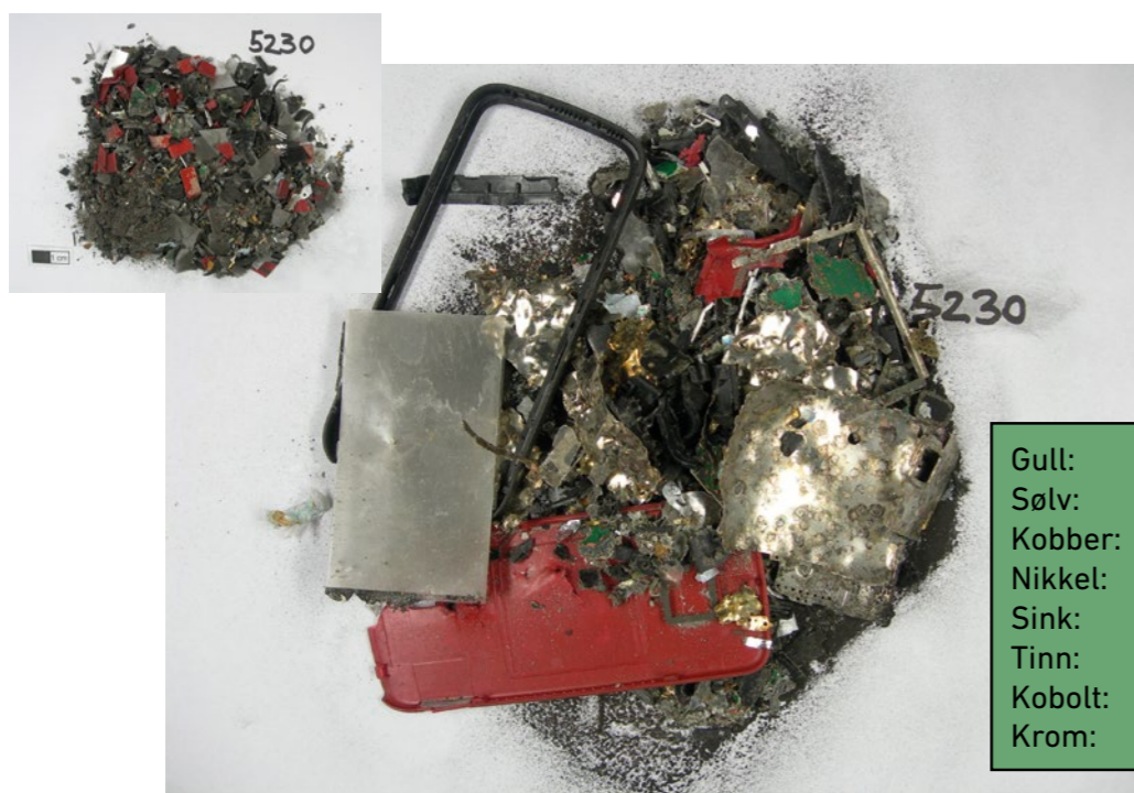
Mobil høyteknologi er avhengig av en lang rekke mineralske ressurser. Eksemplet over viser et utvalg av metaller analysert i en nedknust Nokia 5230 mobiltelefon. 8
