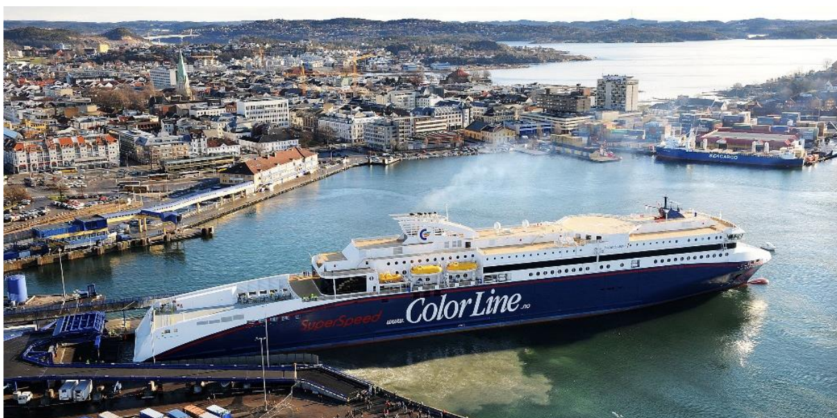
Color Lines SuperSpeed I til kai i Kristiansand. Skipet har blitt ombygd for bruk av landstrømanlegg. Også Superspeed II har fått støtte. NOx-fondet har innvilget støtte med totalt 15 mill. kr og en reduksjon på 67 tonn NOx til landstrømløsninger for de to båtene. Foto: Color Line.
